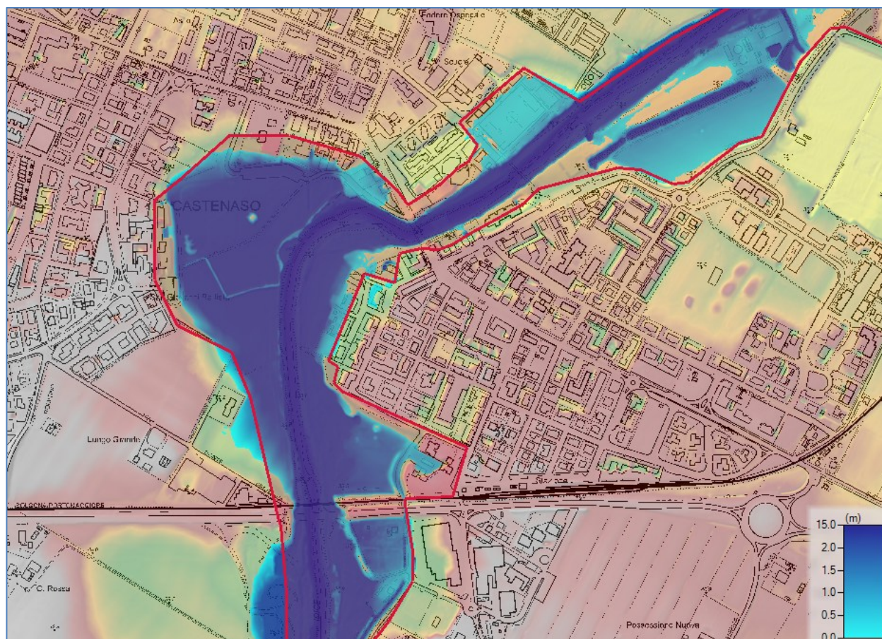
Fig. 37 Torrente Idice T50 9 ore: aree inondabili sovrapposte alla perimetrazione 16-18 maggio 2023 (in rosso)
